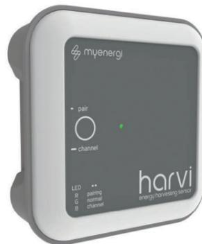
17. 1. Bringen Sie harvi in den Paarungsmodus, indem Sie den entsprechenden Taster am harvi drücken, bis die LED blau blinkt. Der harvi bleibt 2 Minuten lang im Paarungsmodus. (Die Anzahl der blauen Blinksignale zeigt den Kanal an.)
