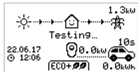
6. Das Boost startet entsprechend zu dem spätmöglichen Zeitpunkt, um die eingestellte Menge an Energie zu erreichen. Wenn der aktuelle Aufladezustand ausreichend ist, wird das Boost nicht erforderlich sein und wird gar nicht ausgeführt.
