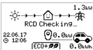
zappi überprüft den Fehlerstromschutz und die Schutzleiterfunktion, bevor der Aufladeprozess eines Fahrzeugs gestartet wird.
